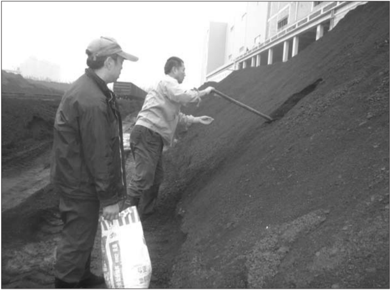
工作人员在煤垛上凿洞采样,之后对煤炭9项指标化验。
