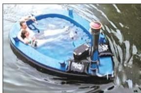
这艘小船的设计相当特别,它同时也可以注入水并加热,变成一个热水浴池。设计者称,这艘名为“HotTug”的小船,空船时最多可以同时乘坐六人。发动机有电力和汽油两种能源选择,可完全独立运行。船头处装有一个加热器,可以在船内装入2000公升水后,慢慢加热水温。不过要这一大缸水完全变成热水,需要等待3个小时,时间稍长了一点。
