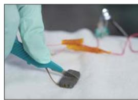
全世界的科学家一直致力于研发自我修复型材料,而近期斯坦福大学的一个团队取得了显著的成果。他们成功设计出一种只能在室温下进行自我修复的材料,更神奇的是该材料能对触摸做出反应。这种可以在受到损害后30分钟之内完成自我的完全修复的人造材料由结合了镍离子的塑料聚合物构成,其可塑性使得其具有优良的导电性。试验表明,这种材料具有良好的使用寿命。即使在同一位置被切割50次之后,试验样本还是能够保持其原有的强度。目前,该团队正在努力使该材料变得透明且具有弹性。这样这种材料便可以用于电子设备的制造,比如制造智能手机的显示屏。
