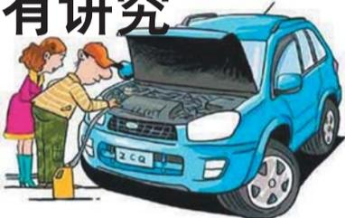
冬季又到了使用暖风季节,暖风系统在停止使用很长时间后,也会出现故障,所以您要先试一下有没有热风、风机运转有无异响、风管是否通畅。有时遇到暖风水管中的防冻液长期不流动,凝结堵塞了循环管路的情况,虽然不影响行车,维修起来却十分麻烦,因此有了问题一定要及时到修理厂修理。
