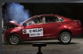
◆正面100%重叠刚性壁障碰撞试验
