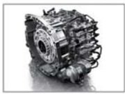
6速干式双离合变速器 技术领先, 换挡平顺、迅捷
