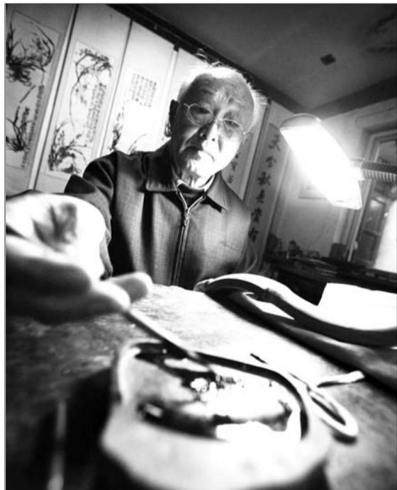
挑出一块泛着柔和色泽的金黄色楷木,经过整形变成素胚,用毛笔描画出福禄图案,再用尖刀切去多余的木块,慢慢地削,缓缓地锉,打磨,上蜡……完成一架精致的如意前,颜景新已经把制作楷木雕的12道工序刻在了心里。
