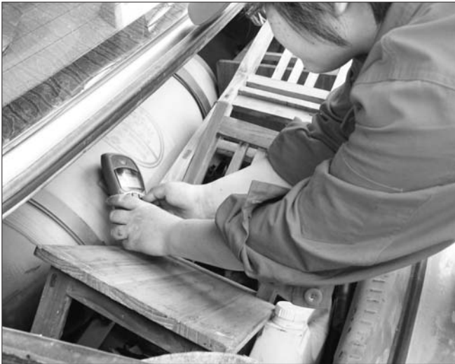
一名工作人员正在扫描气瓶的电子标签。(资料图)
