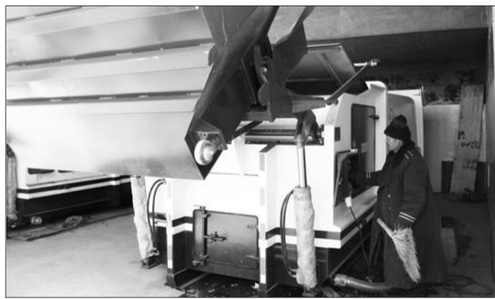
压缩式垃圾中转站建成后,王志刚每天不用再费力打扫垃圾池了,主要工作就是按下电钮,把垃圾斗里的垃圾倒入垃圾箱,然后垃圾箱就会自动压缩,增加了垃圾储存量。
