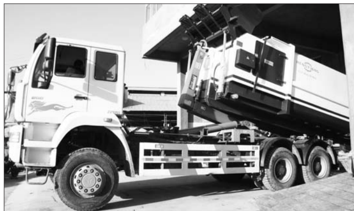
李相勇开的新式垃圾清运车与压缩式垃圾箱配套,自动将垃圾箱拖至车上,到垃圾场后,打开垃圾箱的后门,启动车的液顶顶,垃圾便会自动倒出。
