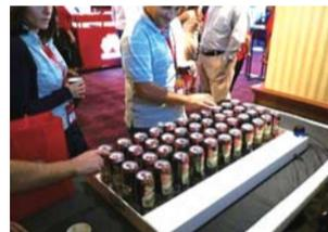
日前，布拉格酿酒商在某展会上展出了一款用44个啤酒罐打造的特别键盘。用户轻敲这些啤酒罐时，啤酒罐键盘就能自动与安置在墙上的显示屏进行连接，通过数据的分析和控制，能像传统键盘一样进行输入。
