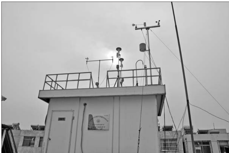
◀在济宁市城市空气质量自动监测中心屋顶上,类似“蘑菇”的就是监测PM2.5的旋风式切割器。
