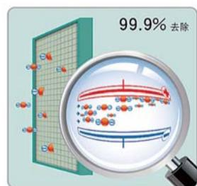
HIFD强电场净化 荷电颗粒物随气流被吸入强电场HIFD净化模块,荷电颗粒物受电场作用吸附截留,空气得以净化。
