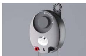
据国外媒体报道,英国的设计与创新机构deciwatt.org新推出一款重力供电的灯,有望为全球还没用上电的15亿人带来光明。其工作原理是用一袋沙子拉动一根穿过一个发电机装置的绳子,从而产生电,为一个LED灯提供动力。其制造者称,为升起沙袋拉绳子3秒钟,可使LED灯泡发光最长30分钟。
