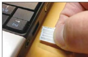
近日,日本一家存储科技公司近日研发了一款“纸质”U盘,其原理是将存储芯片印刷于3层普通纸张的夹缝中,再通过数条导电轨来读写数据。
