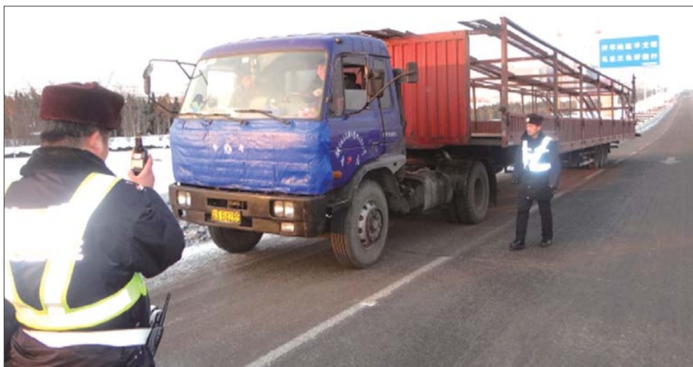
这辆改装车长29米,比原车长了近一倍。图片由通讯员提供
