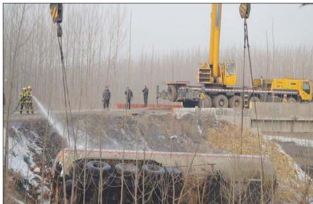
▲吊车对翻入沟底的氨气槽罐进行起吊。
