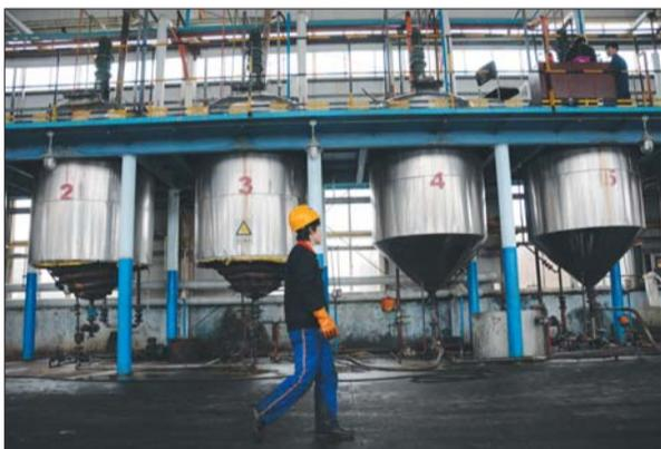
融化后的地沟油会被抽到这些反应釜中,在这里面地沟油经过一系列的物理和化学反应,变成生物柴油。
