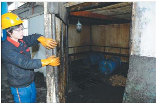
因为天冷,地沟油会凝固在桶内,进入加工车间后需要放入密闭的加热屋里加热,以便油脂融化进行加工。
