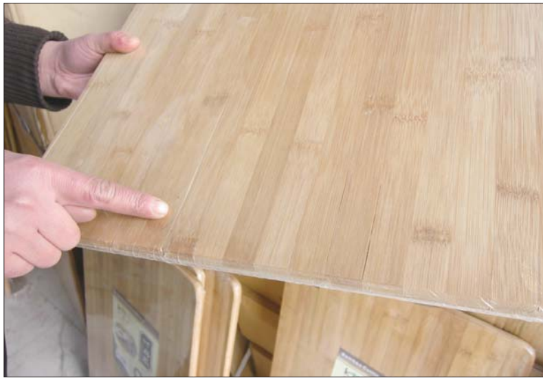
大部分菜板存在裂缝质量问题。本报记者 牟张涛 摄
