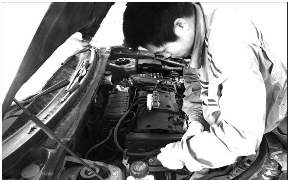
日照市枣庄路上一家燃气改装厂内,一名工作人员正在为一辆轿车安装燃气设备。
