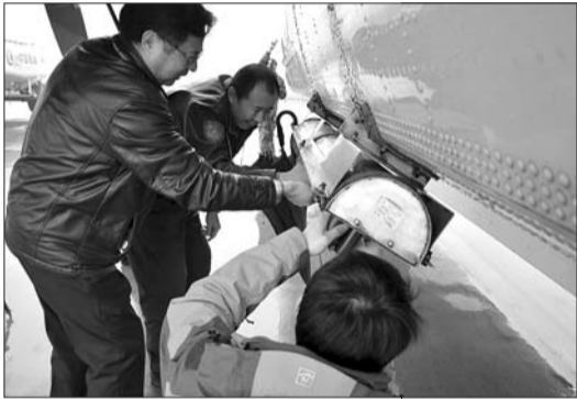
▲在青岛,工作人员正在往飞机上安装用于人工增雨的碘化银增雨弹。(本报通讯员供图)
