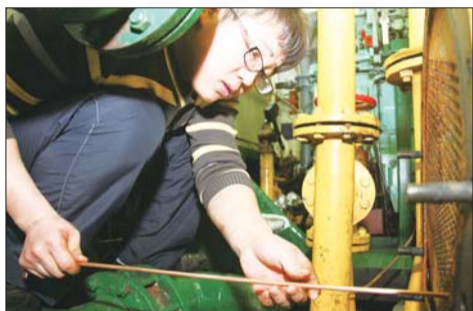
▲维修工在为客船的冷却设备清理“肠胃”,以便于冷海水及时为机器降温。
