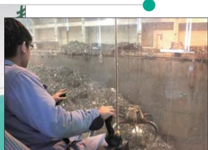
▲20日,在生活废弃物处理中心,工作人员正操作吊机将垃圾“抓”进炉口。
