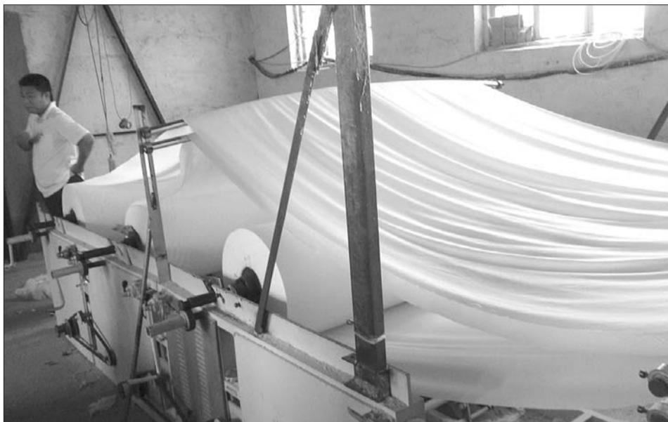
在小厂内,警方当场查获正在加工劣质卫生纸的复卷机。(警方供图)
