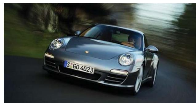
其输出了更加强大的动力。911 Carrera 4S配备3.8升后置水平对置发动机,最大功率为400 hp (294 kW),从静止加速到100 km/h只需4.3秒,最高时速可达297 km/h。配备Sport Chrono组
