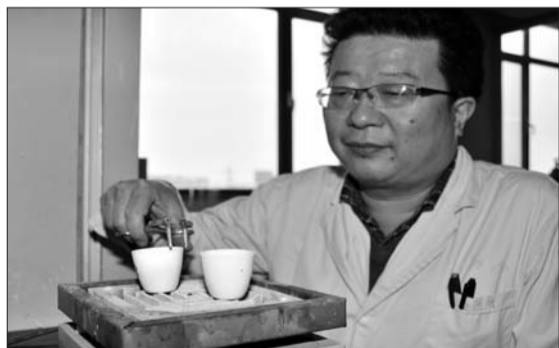
▲检测人员对现场采集的沉降尘(粉尘)进行游离二氧化硅含量的分析。
