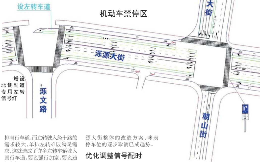
排直行车道,而左转入经十路的需求较大,单排左转难以满足需求,这就造成了许多左转弯车辆驶入直行车道,要么强行加塞,要么违规左转。
