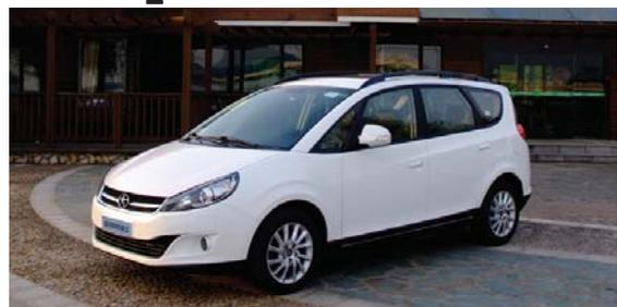
统意义上的“越野车”,但170mm的最小离地间隙比一般城市SUV还要高。配合江淮五星底盘,前麦弗逊后纵臂双连杆四轮全独立悬架,以及205/55R15的宽胎,使其通过性极佳,能够轻松应对各种复杂的路况。
