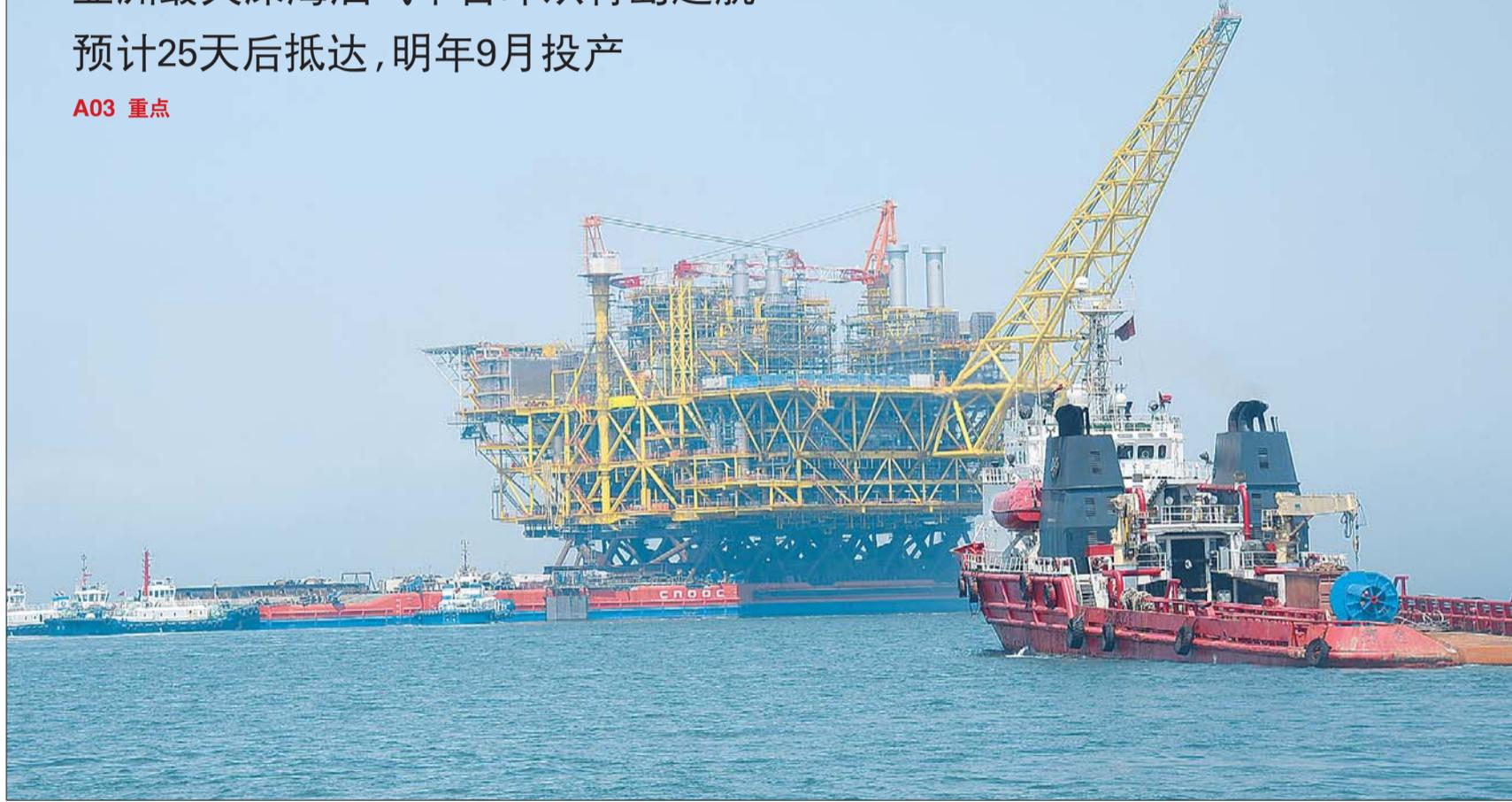
亚洲最大的深海油气平台上部组块5月5日在青岛正式拖航起运南海。上部组块重量超过3万吨,为世界上首次在开敞海域采用浮托法安装,它通过两个拖轮的牵引运到南海。
