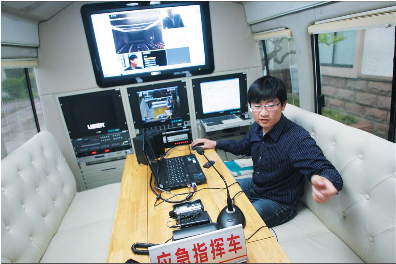
▲地震流动监测车内部将语音通信、视频会议、现场音视频、图像的采集以及数据信息的处理集于一体。 本组图片由本报记者 赵金阳 摄
