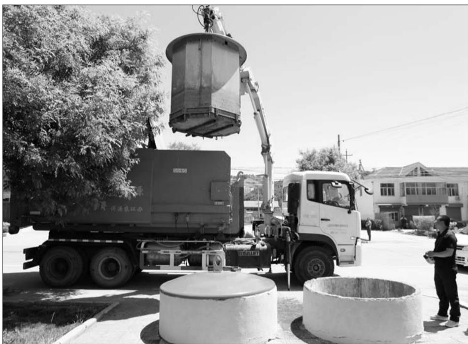
▲工作人员用遥控装置操作吊臂,将深埋式垃圾桶内的垃圾集中收集到运输车。本报记者 王鑫 摄
