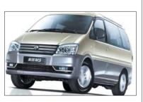
座椅等舒适性配置。在动力方面,2013款菱智M5采用了1.9T、2.0L及2.4L三种排量车型,分别搭载1.9T涡轮增压柴油发动机、三菱4G94发动机及三菱4G69发动机,为当前公商务人士的主流之选。
