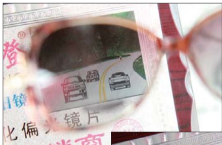
正规厂家生产的偏光太阳镜可以看到测试卡上的汽车。
