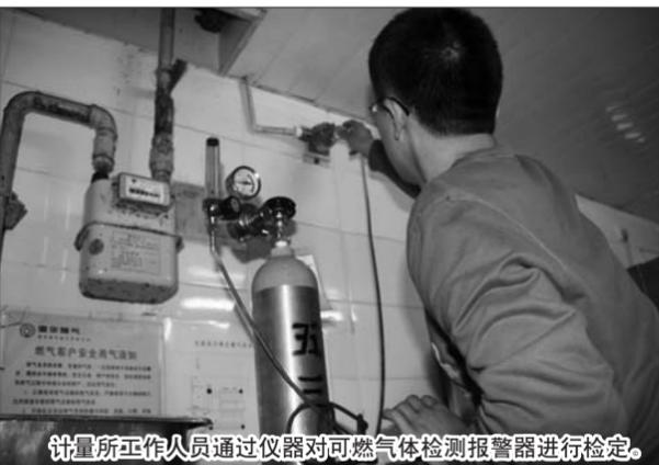
计量所工作人员通过仪器对可燃气体检测报警器进行检定。
