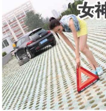
▲ 1.车辆熄火，拉好手刹，将警示牌放在事故车后50-150米位置处。
