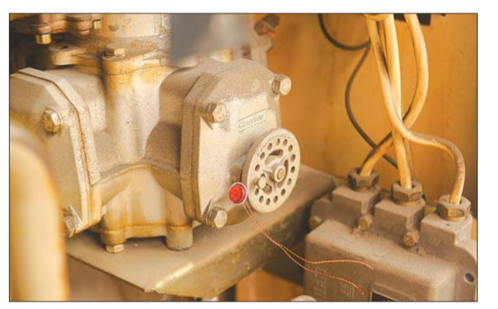
加油机的流量阀门上有铅封,防止私自改流量作弊。本报记者 戴伟 摄
