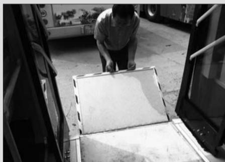
车后门位置设有一块可以拉动的地板,将地板拉开后就成了连接地面和公交车的坡面,方便乘坐轮椅的乘客无障碍上下车。
