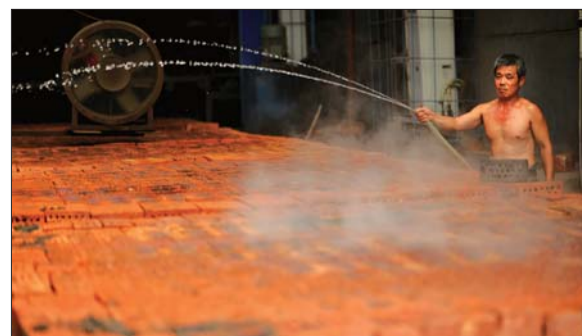
▲出炉的窑车经过一天一夜后温度依然很高,需要洒水降温。
