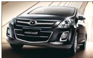
13款Mazda8全新升级的2.5L发动机匹配5速手自一体变速器,最大输出功率达120KW,峰值扭矩226N·m,无论是城市代步还是旅途跋涉,都可体验澎湃动力。灵活多变的座椅组合让您倍感舒适,马自达8是唯一一款带双侧电动门的,而且
