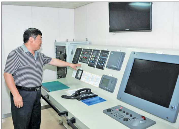
▲海大客运有限公司总经理辛华介绍,生生2客滚轮船上的安全返港系统。记者 王震 摄
