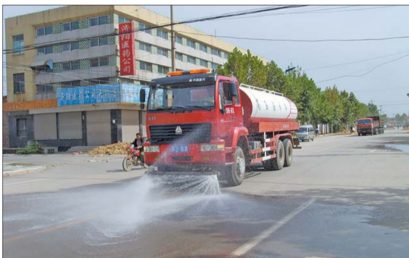
高压洒水车在冲刷作业。
