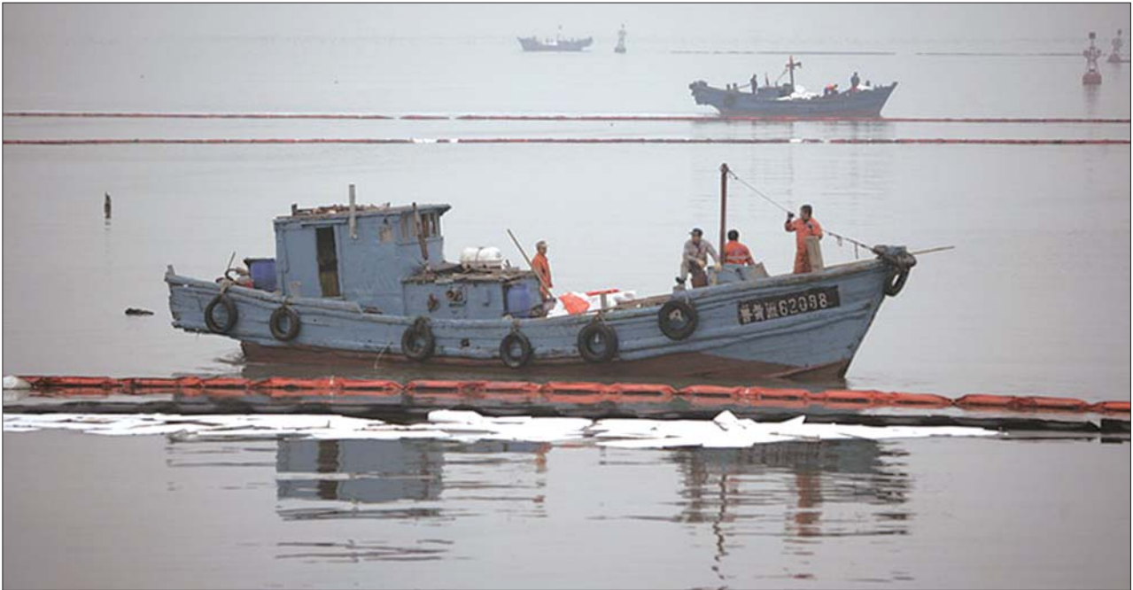
23日,打捞船只正在海面设置围油栏。 本报记者 张晓鹏 摄
