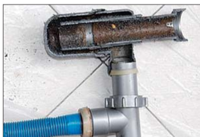
腐蚀老化的管道
