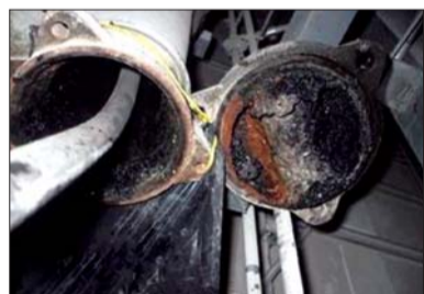
腐蚀老化的管道
