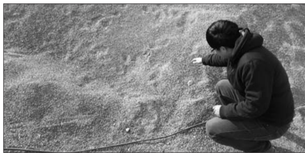
建筑垃圾经各道工序处理后变成再生骨料。
