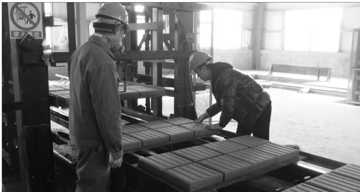
工人将建筑垃圾加工而成的成品建材从机器上搬下。 本报见习记者 臧振 摄
