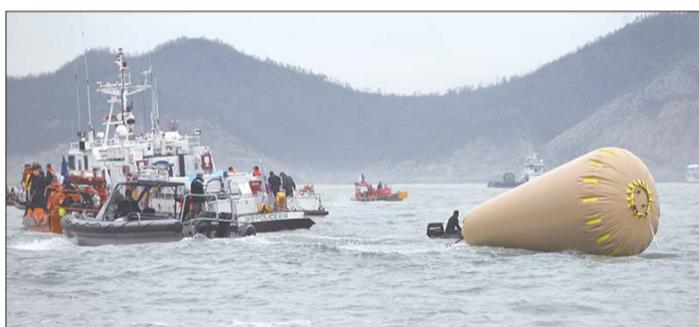
为维持沉没客轮的浮力,韩国军方在事发海域投入数个气囊(空气袋)。 新华社发
