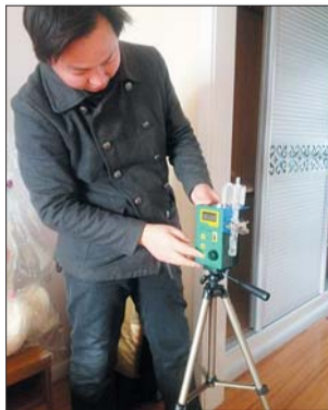
工作人员进行室内甲醛检测。
