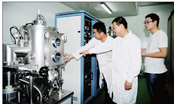
青年工作者在聊城大学磁控溅射制膜实验室进行科研。
