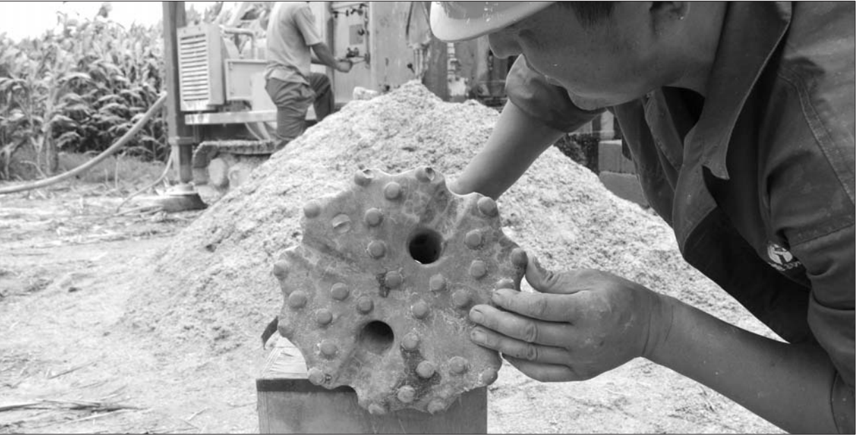
钻头上用来磨碎岩石的合金豆已被磨平甚至磨碎。 本报记者 张璐 摄
