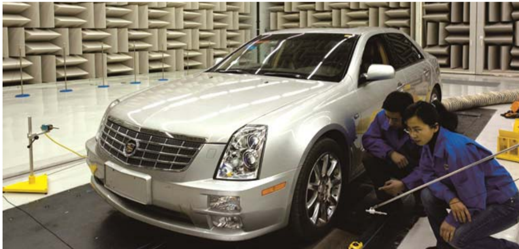
“金耳朵”营造图书馆级静谧空间——泛亚工程师认真监听判断噪音来源。
