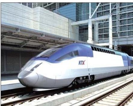
**七、韩国“KTX”高铁。**韩国的KTX(高速铁路:Korea Train Express)始建于1994年,亚洲金融危机之后,韩国经济发展后重振,KTX得以迅速建成。KTX采用法国TGV-A型推拉式高速动车组,总数为46组,当中12组在法国阿尔斯通制造,其余34组则在韩国制造。被誉为“世界十佳列车之一”。其选择的路线恰在韩国经济最为发达的中部腹地,一头是人口1200多万的韩国首都,也是政治、经济、文化、商贸中心的首尔;另一头是韩国最大港口、第二大城市釜山。2004年4月1日正式开通。
