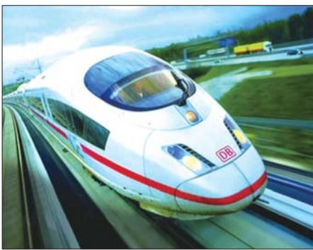
**四、德国ICE。**赫赫有名的ICE(城际特快列车,InterCityExpress,简称ICE)是以德国为中心的高速铁路系统及高速铁路专用列车系列。德国的高速铁路技术储备不亚于法国,1988年他们电力牵引的行车试验速度突破每小时400公里大关,达到406.9公里。德国的高速铁路,一条是1991年6月建成通车的曼海姆至斯图加特线;一条是1992年建成的汉诺威至维尔茨堡线。目前,德国高速铁路总里程达1287.48公里。
