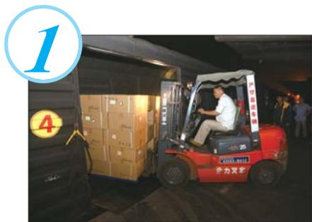
**1 装货上车**——适用小件货物集装化的电动叉车等作业机具,提高了站台装车组织和到站装卸车作业效率。
