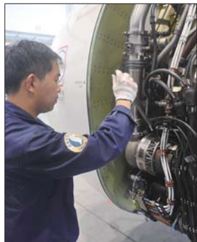
维修人员正在用工具人工转动发动机叶片协助孔探检查。
