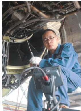
定检人员正在为发动机做孔探。
